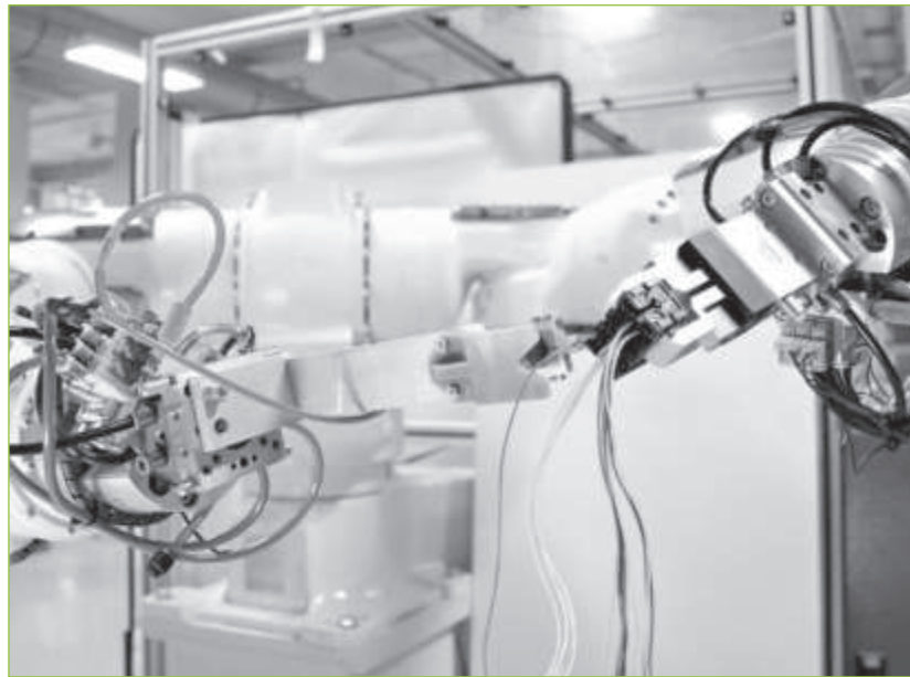
Kabelbaummontage mittels zweiarmigem Roboter (Quelle: FAPS) ■
